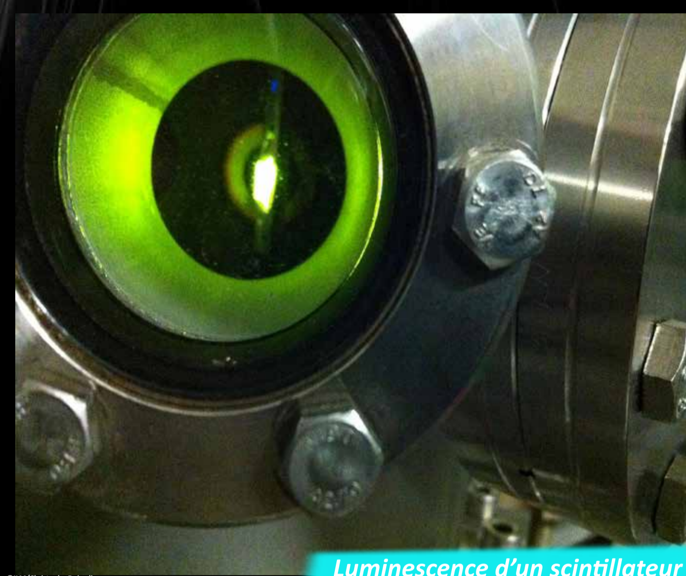
Luminescence d'un scintillateur sous un faisceau d'électrons
