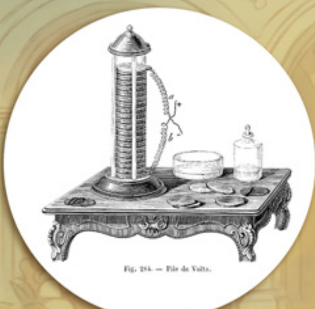
Fig. 254. — Pile de Volta. La pile de Volta Adolphe Quatrefonds, Cours de physique , 1859
